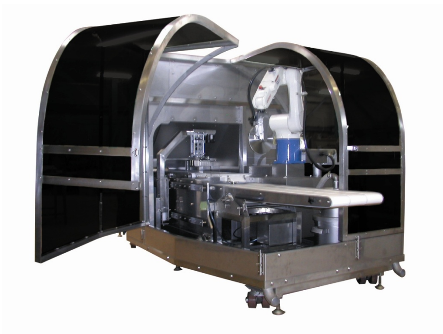
世界初の生魚定貫切り装置 スーパープロフェッショナル
